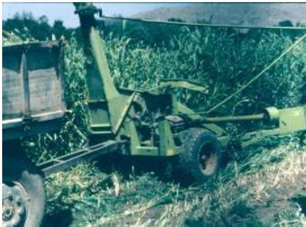
« تصویر ۱۱ ) بخش عقب دستگاه چابر دوردیفه »
